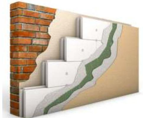
El proceso comienza asegurando las planchas de aislante con el espesor necesario sobre la fachada existente del edificio, utilizando adhesivos potentes y tacos plásticos de gran resistencia mecánica y nula susceptibilidad a la corrosión.
